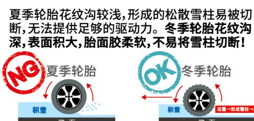
冻结路面实际上凹凸不平，夏季轮胎胎面较硬，无法很好地贴附地面，容易打滑。冬季轮胎胎面宽，胎面胶柔软，能够提供足够的抓地力！
